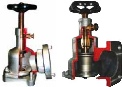
Die selbstschließende Wirkung des Niederschraubventiles ist nur bis zum Einrasten des Sperrstiftes wirksam. Wird der Sperrstift gezogen, kann die Ventilspindel noch 2 bis 3 Gewindegänge aufgedreht werden; dadurch wird der Ventilteller vom Ventilsitz gehoben, die selbstschließende Wirkung ist damit ausgeschaltet.
